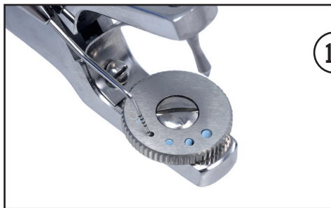
afbeelding 19. Het vrijmaken van de gaatjes zodat de tang weer lekker knipt.
