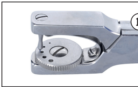
afbeelding 17. Verkeerde positionering van de pons ten opzichte van het gaatje wat zorgt voor problemen met perforeren en beschadiging van de tang.
